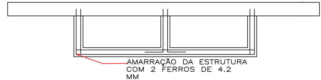
ESQUEMA DE AMARRAÇÃO DO BEBEDOURO SEM ESCALA
